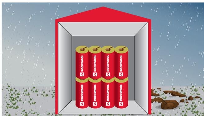
Цилиндры остальных типоразмеров – в горизонтальном или вертикальном положении.
